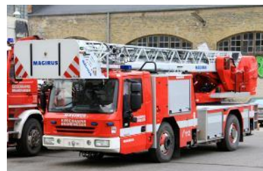
Figur 6 – En af Københavns drejestiger, rækkevidde op til 30 meter
